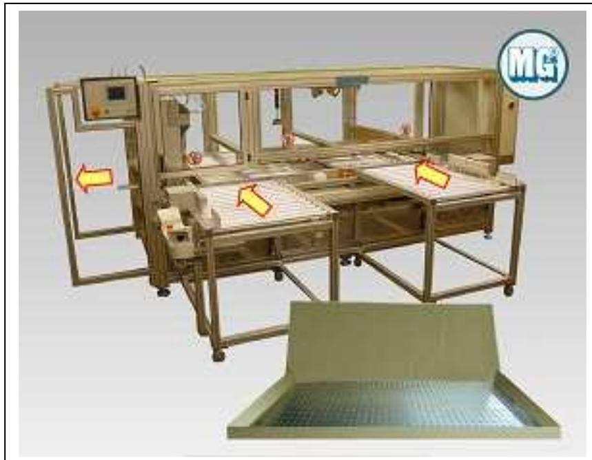
**Sonderheftmaschine SHM B 36-78/4X/MEV**Umschlagkartons mit Kartoneinlage zum Verpacken von Blechen.
